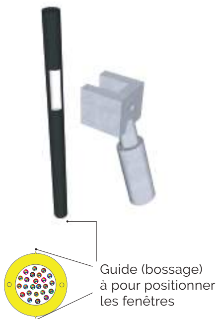
Fig. 139 | Ouverture de fenêtres dans les câbles de la colonne montante
